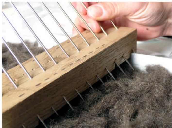
Il Point Frame (particolare della barra mobile dotata di 10 aghi)
